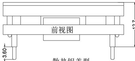
散热铝盖型 34.3*24.1*12.7mm
